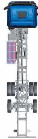
Réservoir GNC à gauche, disponible en combinaison avec un réservoir GNL ou GNC à droite.
