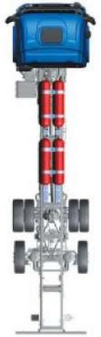
Réservoirs GNC sur le châssis, disponible en combinaison avec :
